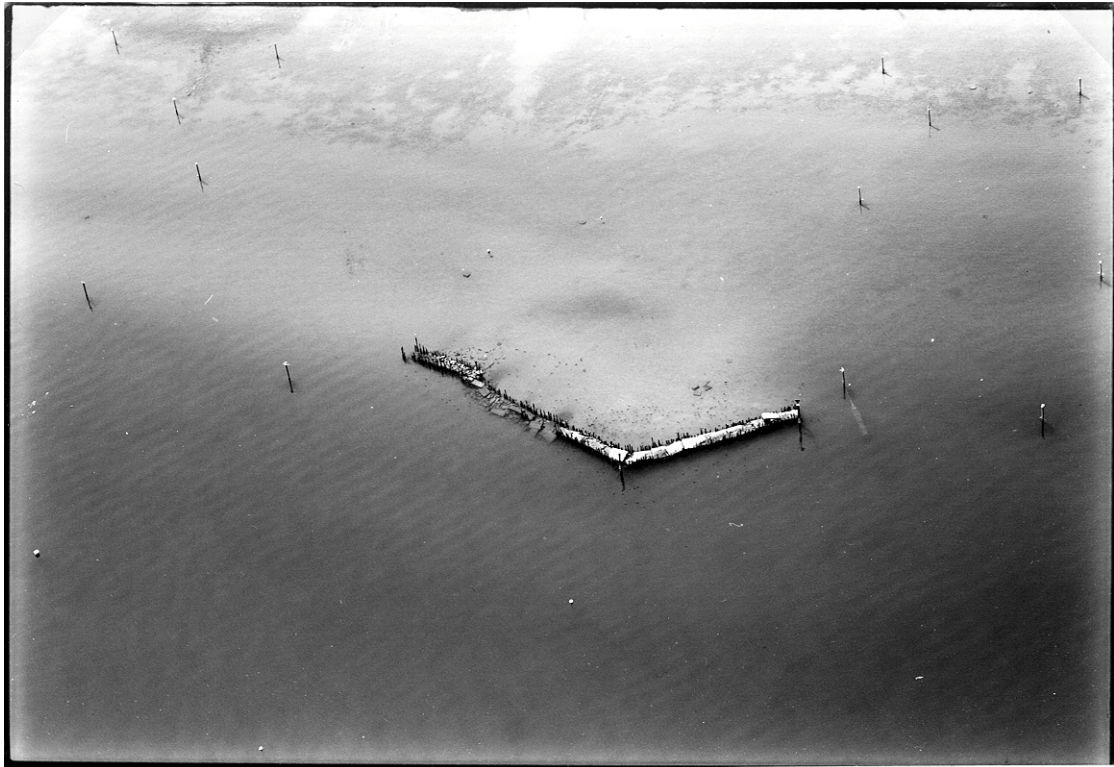
Luftbild der alten Stelli vor Kesswil. Sichtbar sind die beiden Pfahlreihen und die recht aufwändige Füllung mit Sandsteinquadern (Foto: Kantonsarchäologie Thurgau, 1998). Abb. 14
